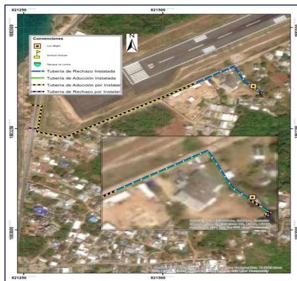
Imagen. Tubería de Aducción y Rechazo
